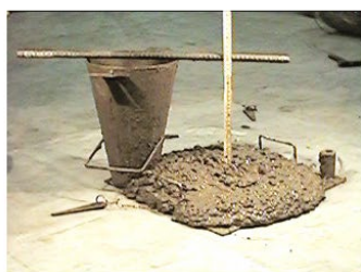
Consistenza S5 slump > 220 mm
