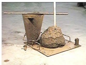
Consistenza S3 slump 100 - 150 mm
