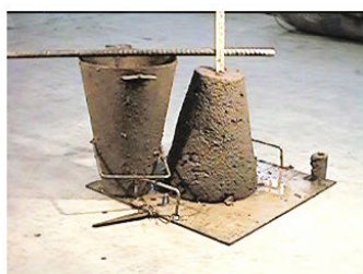
Consistenza S1 slump 10 - 40 mm
