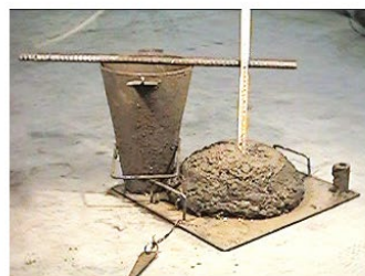
Consistenza S4 slump 160 - 210 mm
