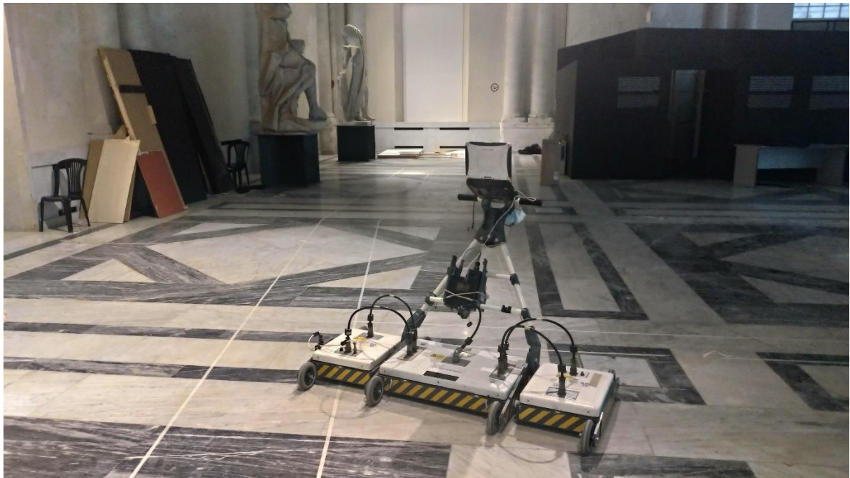
Georadar IDS all'interno del salone della Loggia dei Banchi
