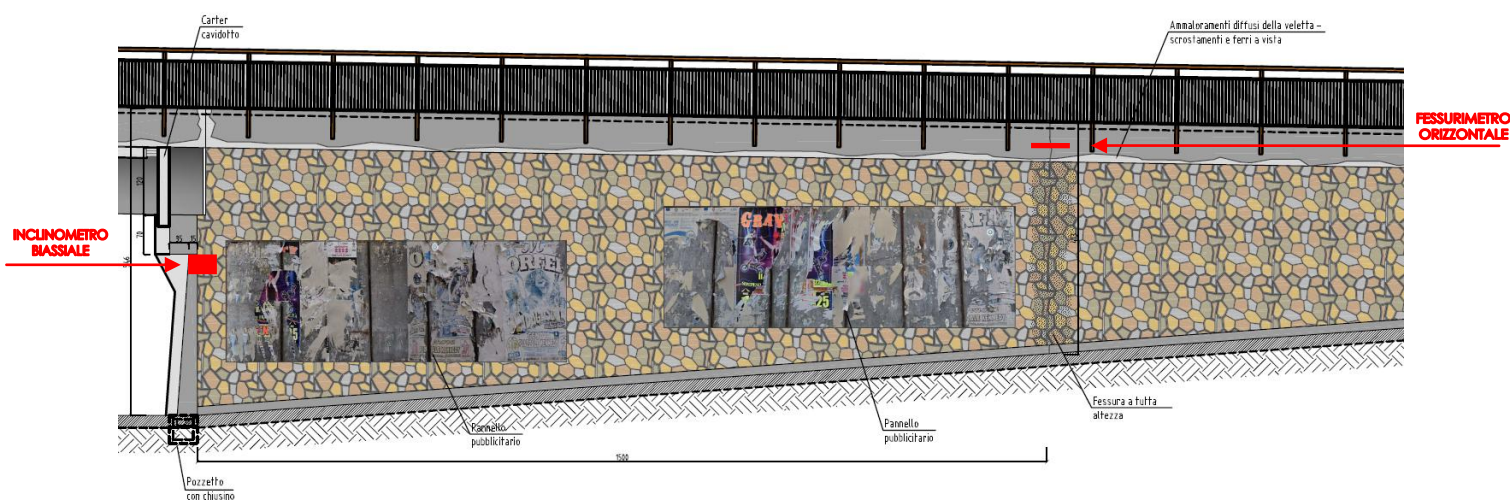
Figura 5 – Prospetto muro andatore - Identificazione posizione fessurimetri ed inclinometro
