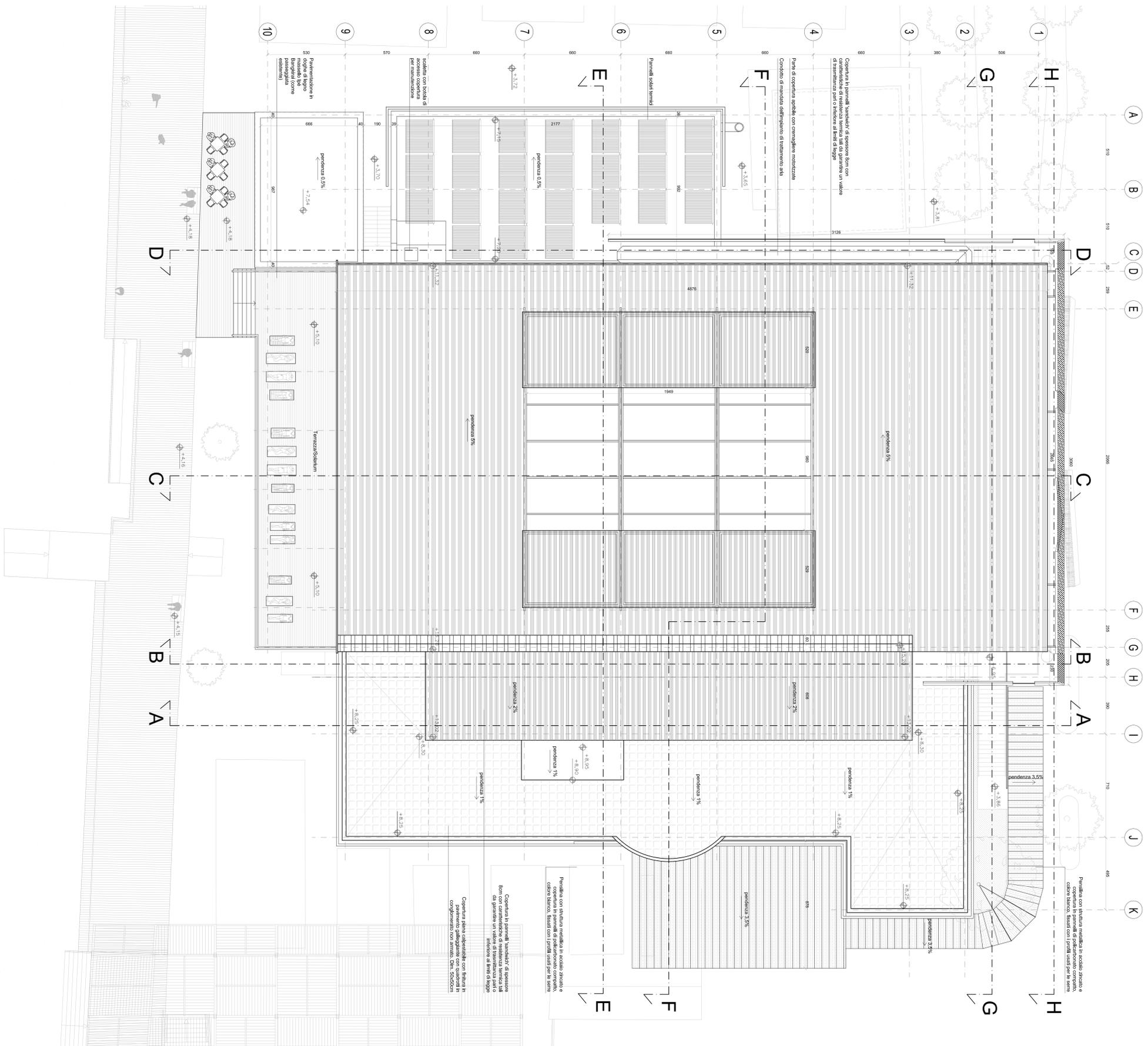
Copertura in pannelli sandwich di spessore 80mm con caratteristiche di resistenza termica tali da garantire un valore di trasmissione pari o inferiore al limite di legge
