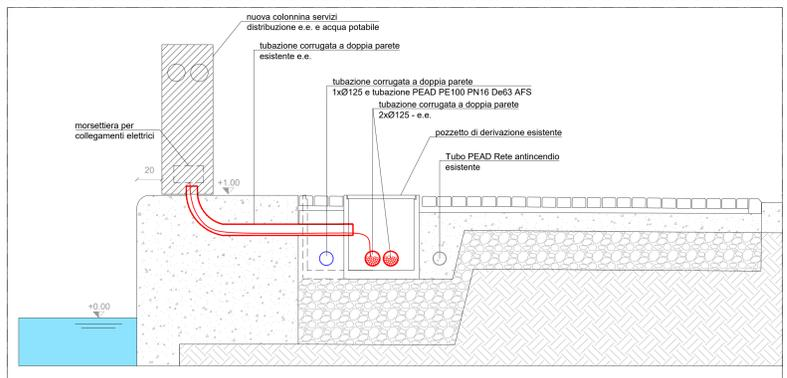
S01 - Dettaglio posizionamento colonnine servizi - 1:20
