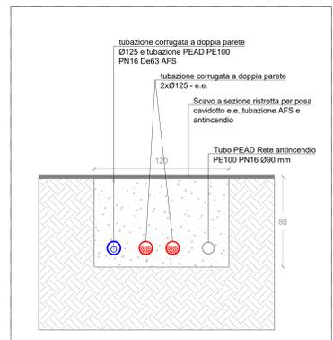
S02 - Dettaglio scavo per posa sottoservizi - 1:20
