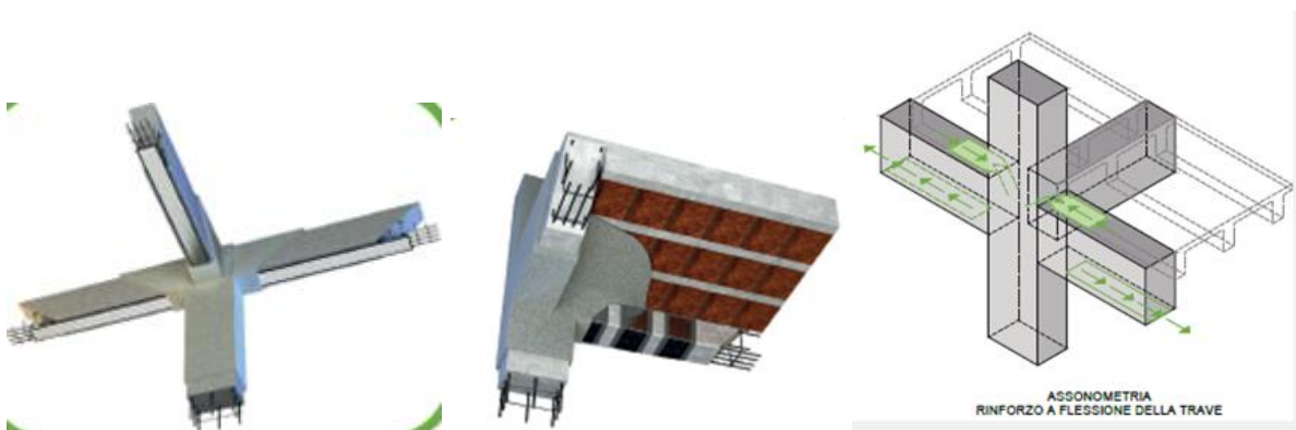
Figura 15: Esempio interventi su trave
