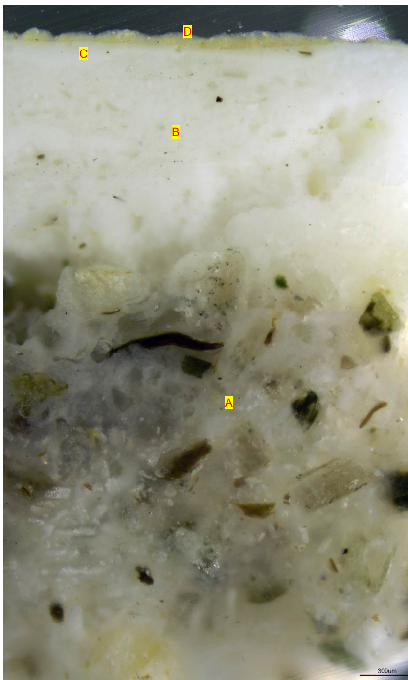
Campione P6 . Fotomicrografia al MPOM in luce riflessa, sezione lucida trasversale N//. Nel riquadro in basso a destra foto del campione tal quale al MPOM.
