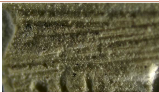
Campione P6 . Fotomicrografia al MPOM in luce riflessa, sezione lucida trasversale N//. Nel riquadro in basso a destra foto del campione tal quale al MPOM.
