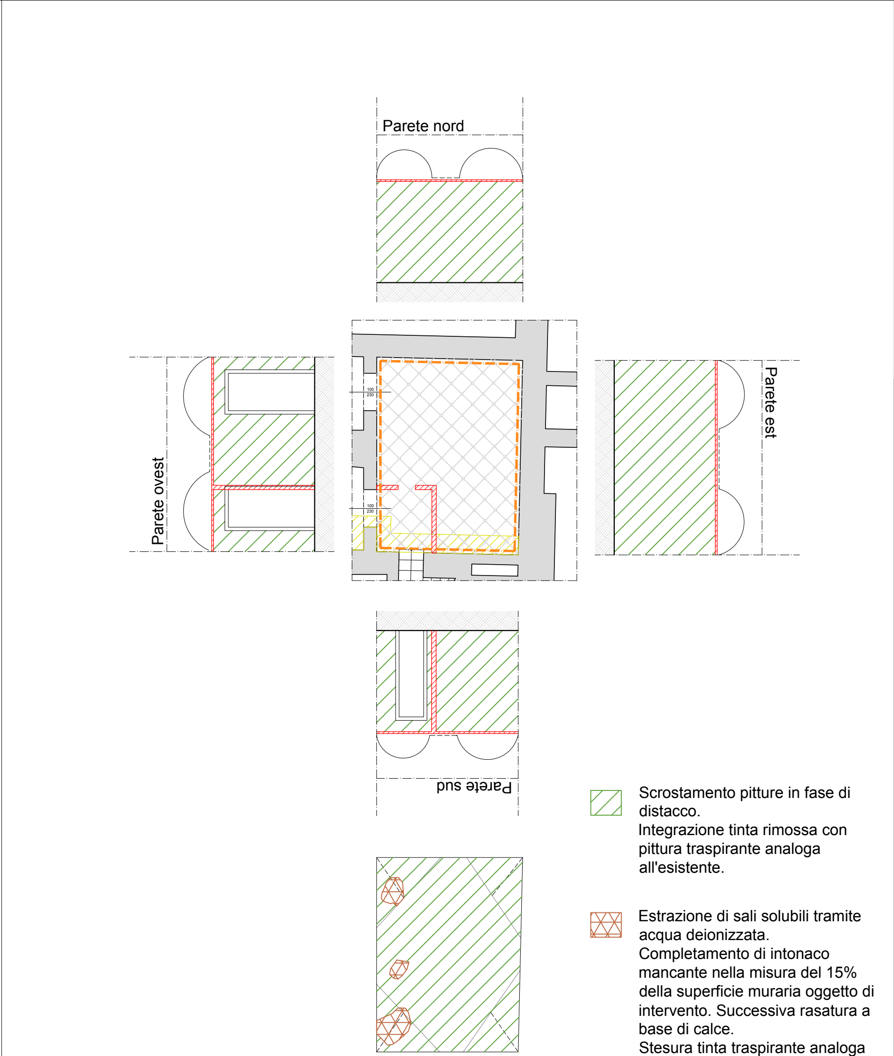
Pianta Soffitto all'esistente Rimozione e successivo ripristino di pavimento in piastrelle in ardesia per passaggio cavi Pulitura di tutta la superficie a seguito delle lavorazioni.
