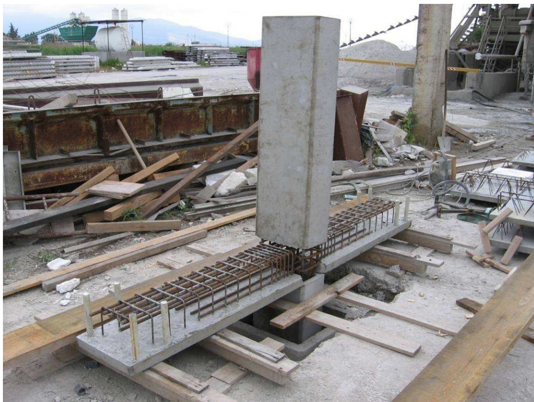
Figura 4 - Un campione prefabbricato TST in fase di realizzazione
