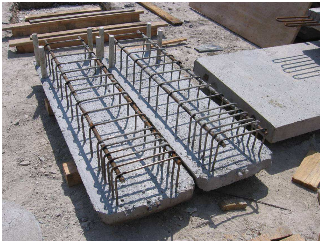
Figura 3 - Fondelli prefabbricati delle travi per la realizzazione dei campioni TST
