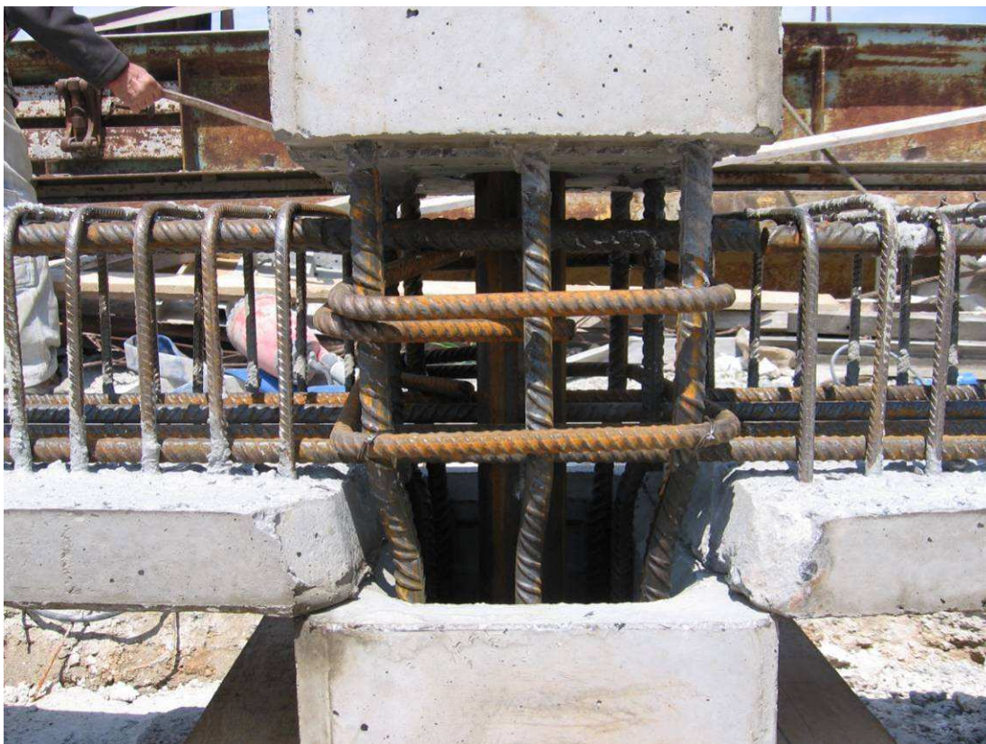
Figura 5 - Particolare del nodo di un campione prefabbricato TST
