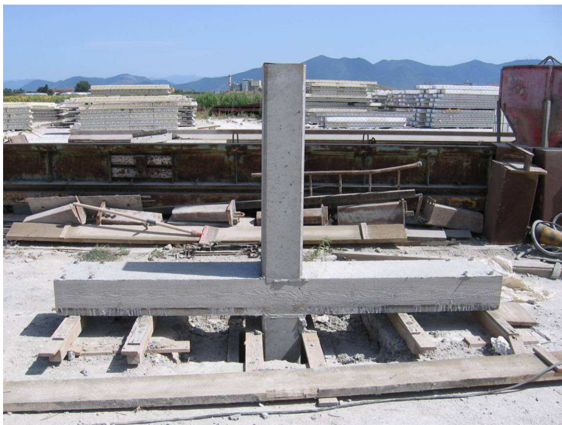
Figura 6 - Campione prefabbricato TST dopo il getto di completamento
