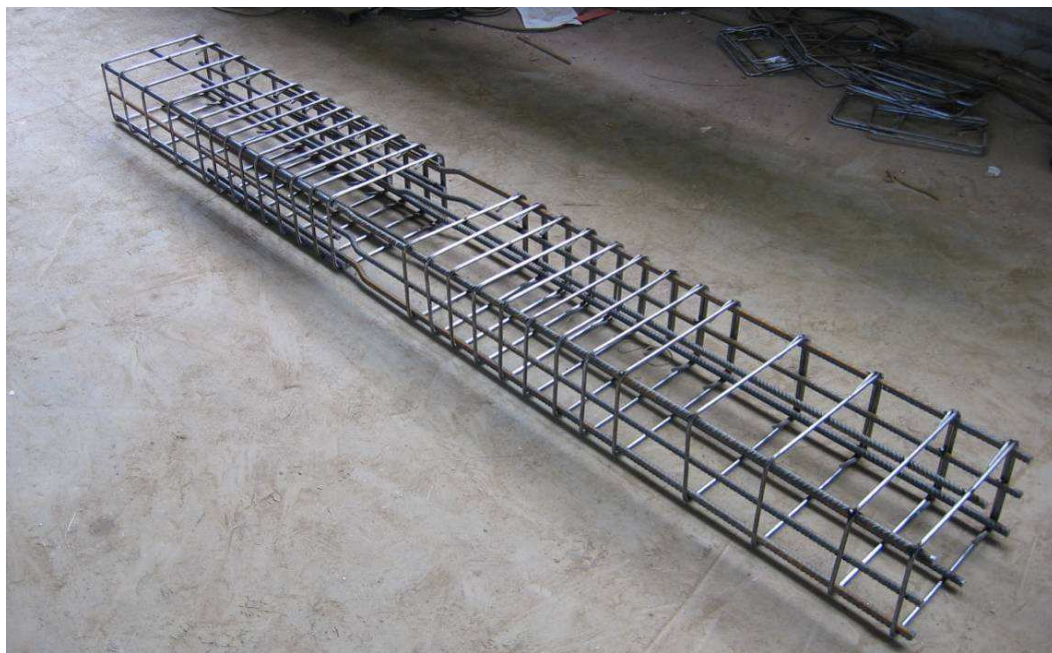
Figura 7 - Armatura del pilastro di un campione
