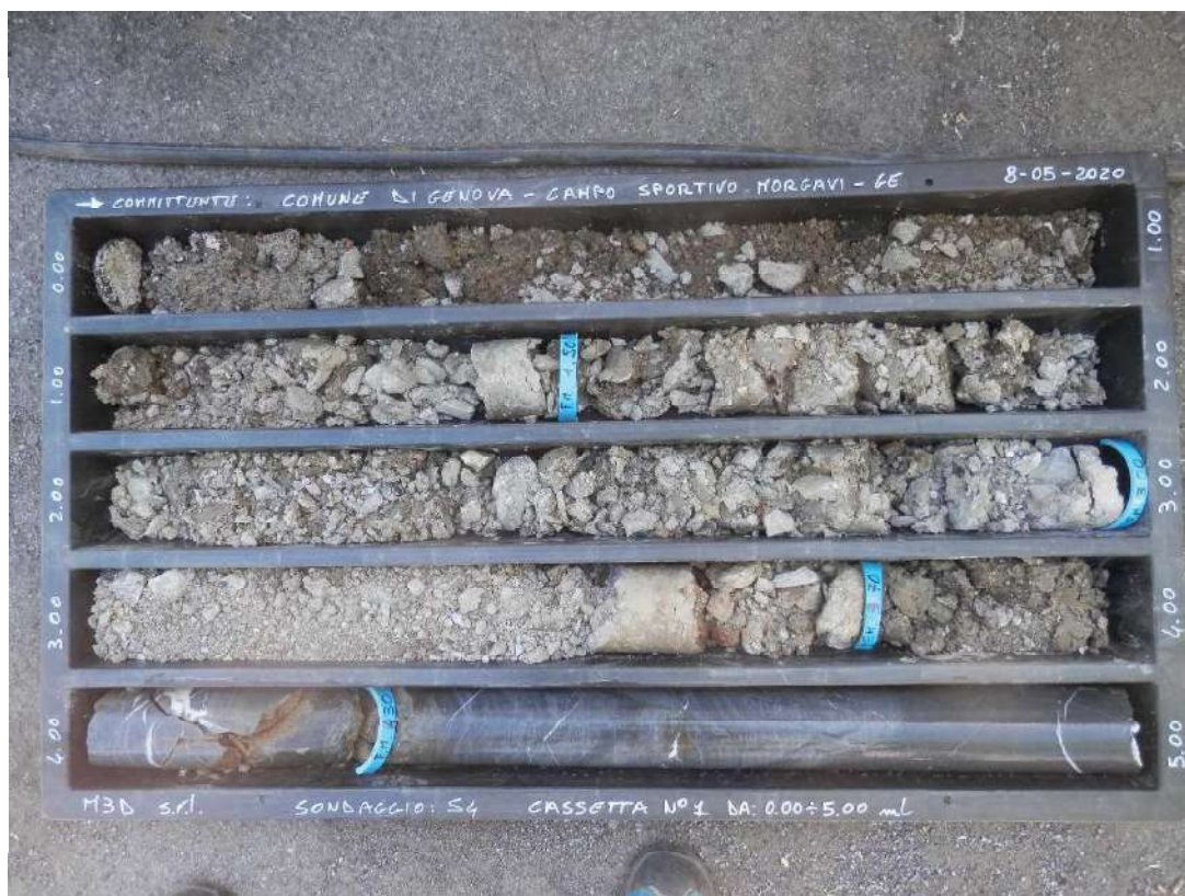
Foto 11 – Sondaggio S4 da 0 a 5 m di profondità.
