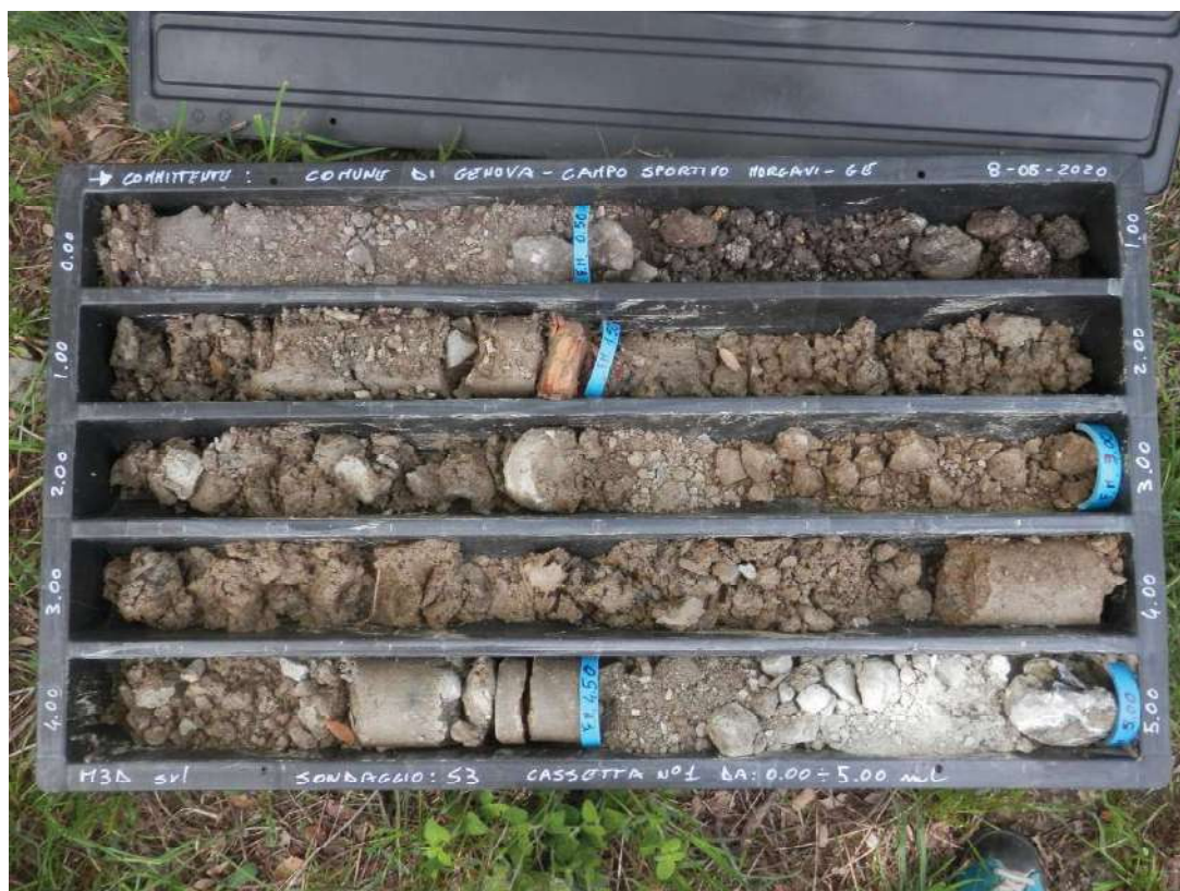
Foto 9 – Sondaggio S3 da 0 a 5 m di profondità.
