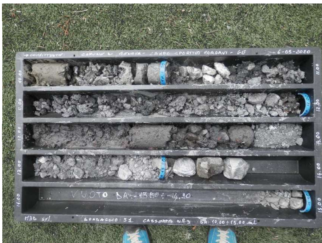
Foto 6 – Sondaggio S1 da 10 a 15 m di profondità.
