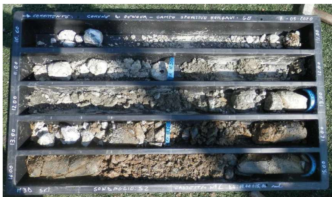
Foto 8 – Sondaggio S2 da 10 a 15 m di profondità; i primi 10 m dal piano campagna sono stati perforati a distruzione di nucleo.
