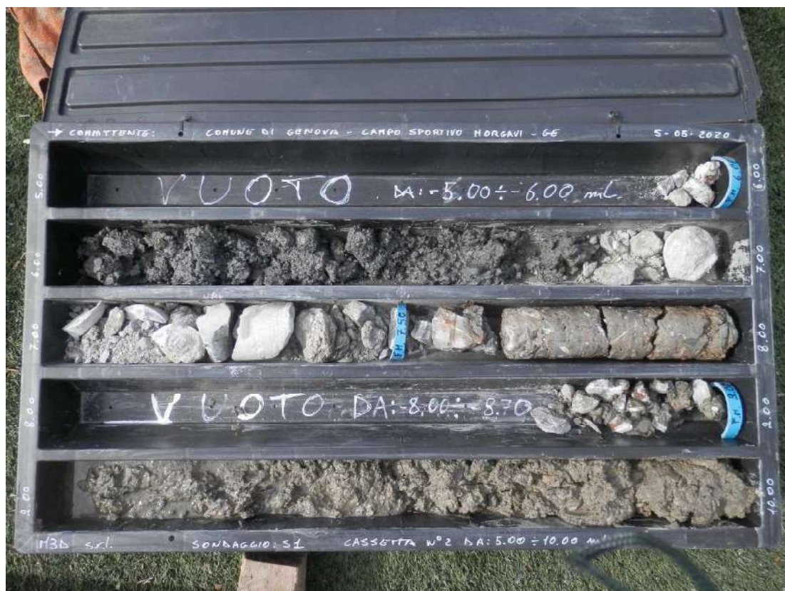
Foto 5 – Sondaggio S1 da 5 a 10 m di profondità.
