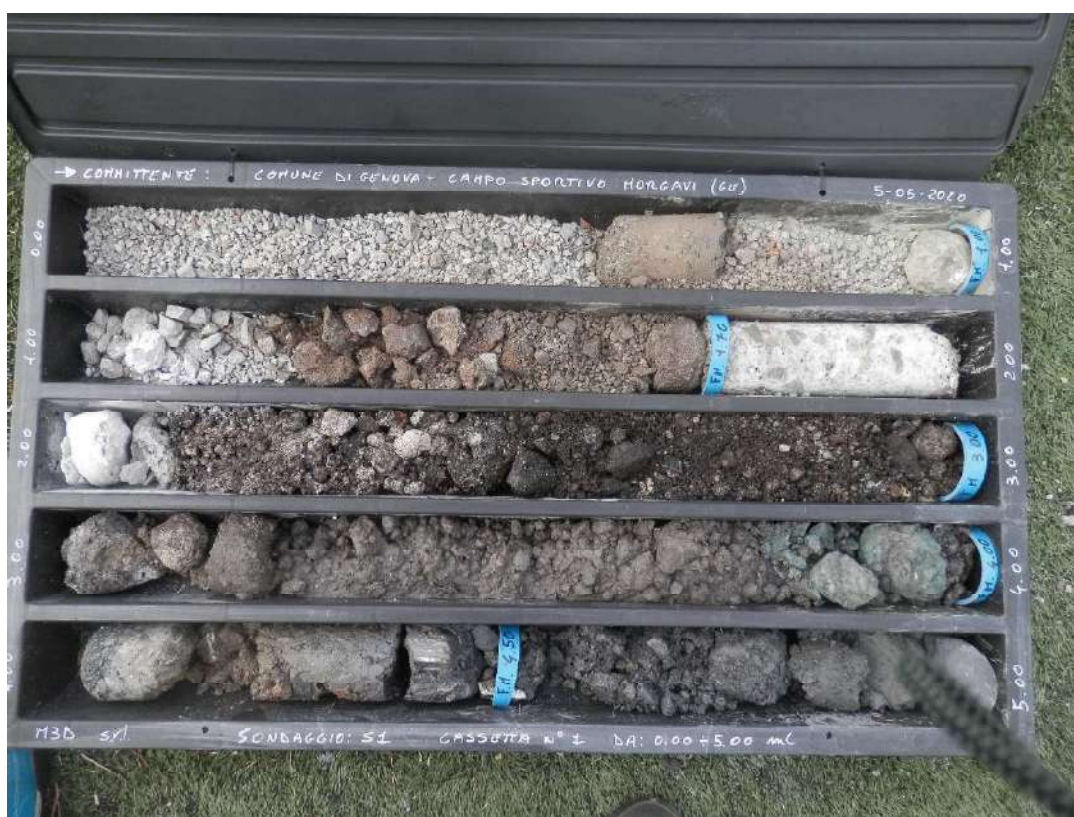
Foto 4 – Sondaggio S1 da 0 a 5 m di profondità.
