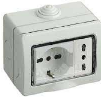
Figura 5: Esempio di cassetta portafrutto a parete IP 55 con installate presa universale e presa italiana
