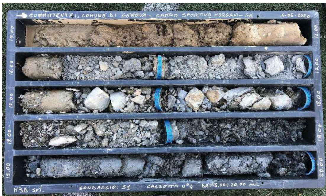
Foto 7 – Sondaggio S1 da 15 a 20 m di profondità.
