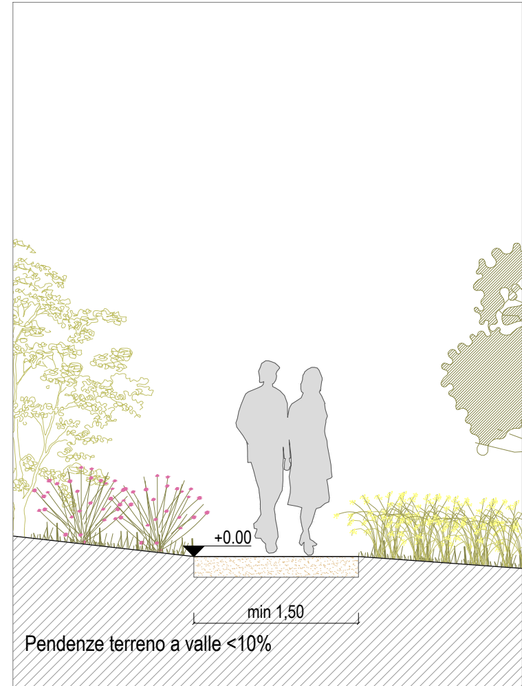
10 SEZIONE TIPO - PERCORSO A RASO 1:50
