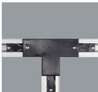
79328.000 Giunto trifase a T Materiale sintetico. Conduttore di terra a destra. Possibilità di alimentazione. Cablaggio passante. Nero CE
