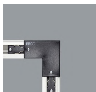
79327.000 Giunto angolare trifase Materiale sintetico. Conduttore di terra all'esterno. Pos- sibilità di alimentazione. Cablaggio passante. Nero CE
