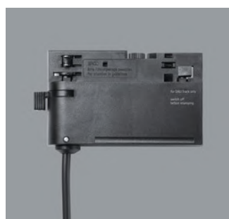
79229.000 Giunto a T DALI Materiale sintetico. Conduttore di terra a sinistra. Possibilità di alimentazione. Cablaggio passante. Nero CE
