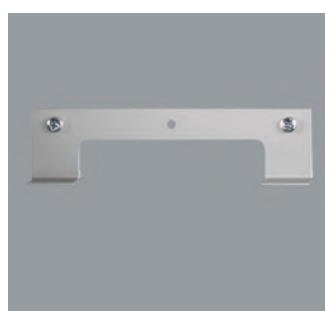
79501.000 Ponte per sospensione per il collegamento lineare dei binari. Metallo, zincato. Il ponte per sospensione può essere inserito successivamente nei binari elettrificati ERCO dall'alto. Carico 20kg. L 180mm, H 47mm.
