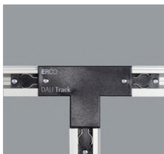
79228.000 Giunto a T DALI Materiale sintetico. Conduttore di terra a destra. Possibilità di alimentazione. Cablaggio passante. Nero CE
