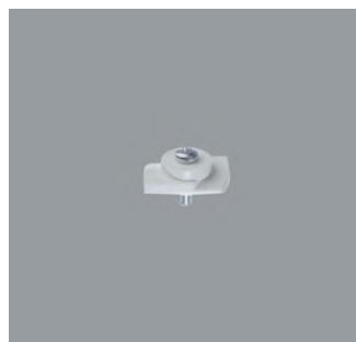
78633.000 Traversino per il fissaggio dei binari elettrificati nei profilati incassati nell'intonaco. Solo in abbinamento a 78350.000
