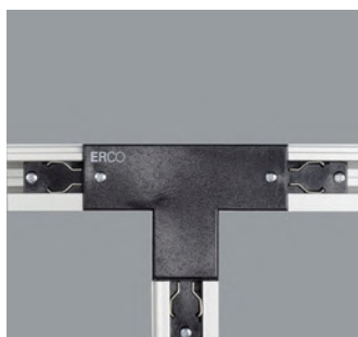
79329.000 Giunto trifase a T Materiale sintetico. Conduttore di terra a sinistra. Possibilità di alimentazione. Cablaggio passante. Nero CE
