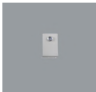
79500.000 Sospensione per binari elettrificati Metallo, zincato. La sospensione può essere inserita successivamente nei binari elettrificati ERCO dall'alto. Carico 15kg. L 30mm, H 47mm.
