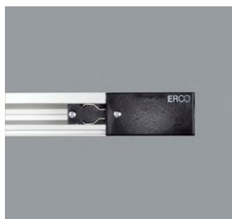
79321.000 Alimentazione trifase Materiale sintetico. Conduttore di terra a sinistra. Nero CE
