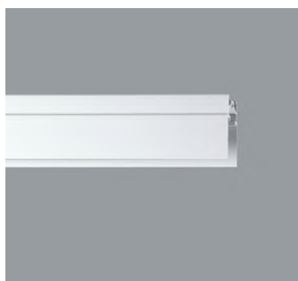
78350.000 Profilato per incasso nell'intonaco Profilato in alluminio, argento ano- dizzato. Per il montaggio di binari elettrificati dei soffitti intonacati. B 40mm, H 52mm, L 3000mm. Peso 3,00kg
