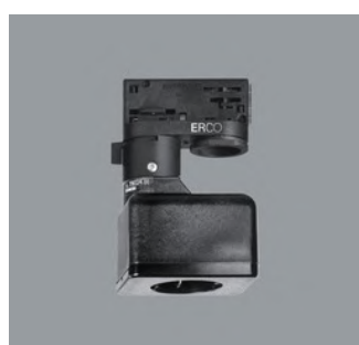
79024.000 Adattatore trifase ERCO con spina Schuko. 250V, 10A. Materiale sintetico. Copertura: Materiale sintetico nero. L 71mm, B 56mm, H 90mm. Nero CE
