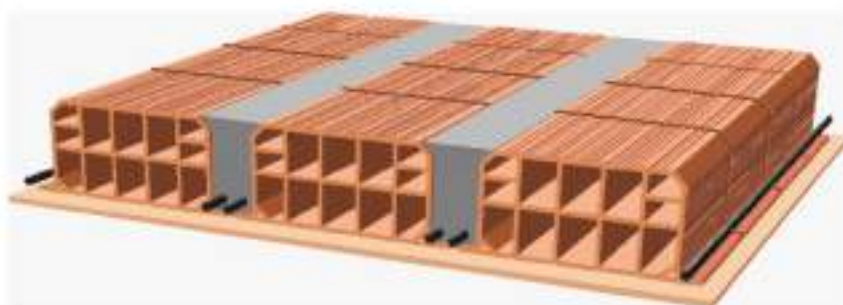
Figura 22.1 - Esempio di solaio in cemento armato gettato in opera 2
