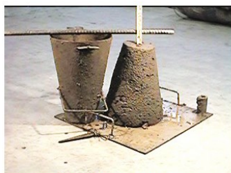
Consistenza S1 slump 10 - 40 mm
