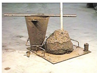
Consistenza S3 slump 100 - 150 mm
