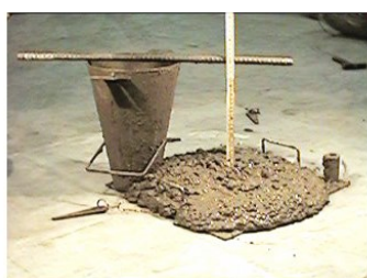
Consistenza S5 slump > 220 mm
