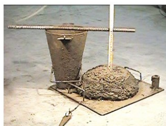
Consistenza S4 slump 160 - 210 mm
