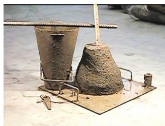
Consistenza S2 slump 50 - 90 mm
