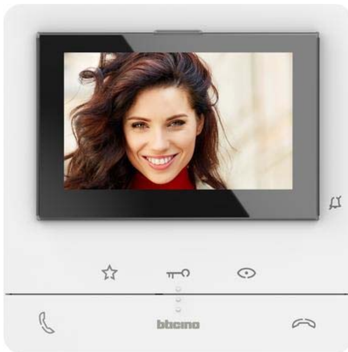
Figura 3 – Posto interno videocitofonico 2 fili a parete per il piano secondo classe 100V16B con display LCD a colori 5", 2 tasti fisici per il comando delle principali funzioni videocitofoniche – risposta e chiusura della chiamata – ed è dotato di 3 tasti a sfioramento per il comando delle principali funzioni – apertura della serratura e accensione luci scale
