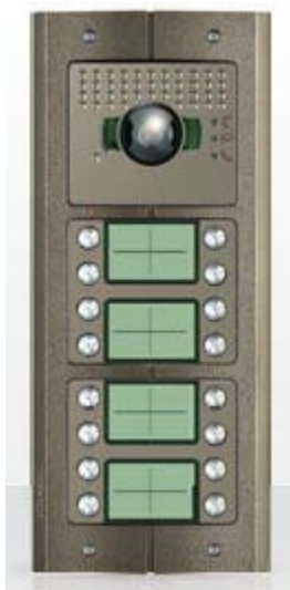
Figura 2 – Posto esterno dotato di pulsantiera esterna audio-video con telecamera a colori montato a parete, tipo SFERA ROBUR in esecuzione antivandalo con tetto antipioggia 2 moduli: un modulo audio video e un modulo 8 pulsanti doppia fila
