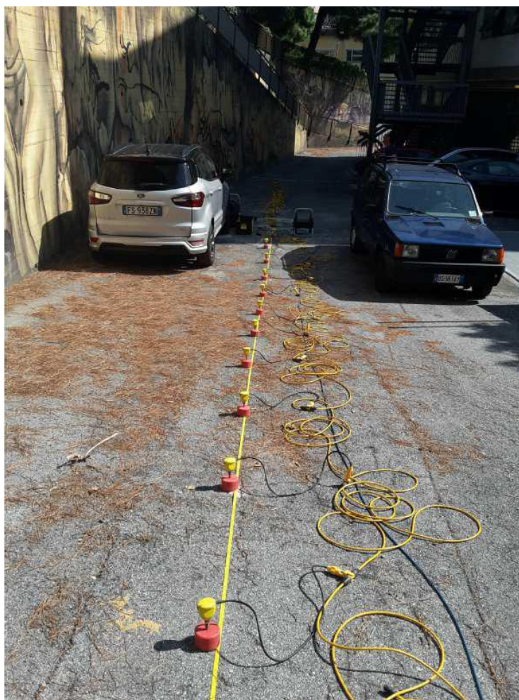
Figura 21 Sismica a rifrazione (foto scattata da geofono 1)
