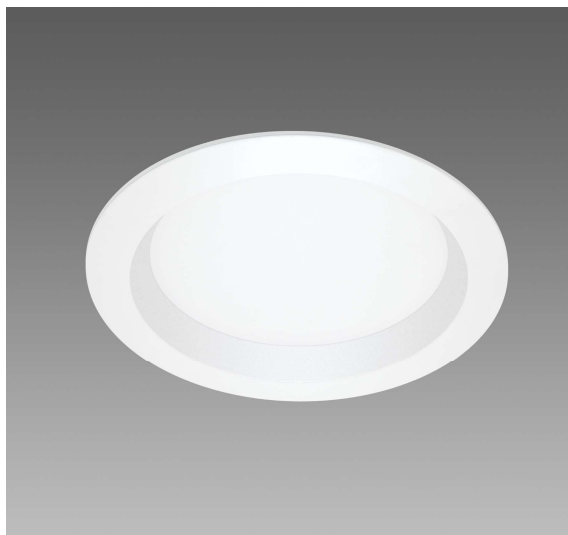
Immagine 1 – Corpo illuminante a plafone tipo D1 e D2 Disano Compact CRI95 – 883 diam.180mm IP44 Pot.14W e 20W col.bianco 1520lm e 1950lm 4000K RG0 o eq.
