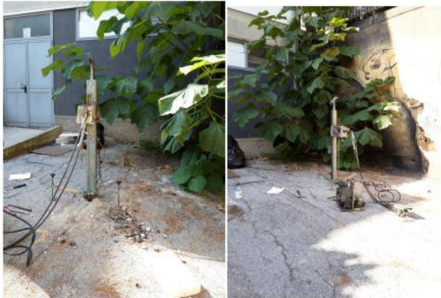
Figura 2. Esecuzione prova penetrometrica esterna
