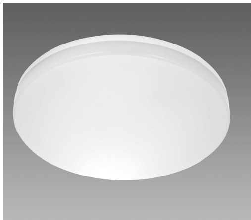
Immagine 2 – Corpo illuminante a plafone tipo D3 Disano 748 Oblò 2.0 IP65 Pot.24W (2555lm) CRI 83 o eq. colore bianco RG0 o eq.
